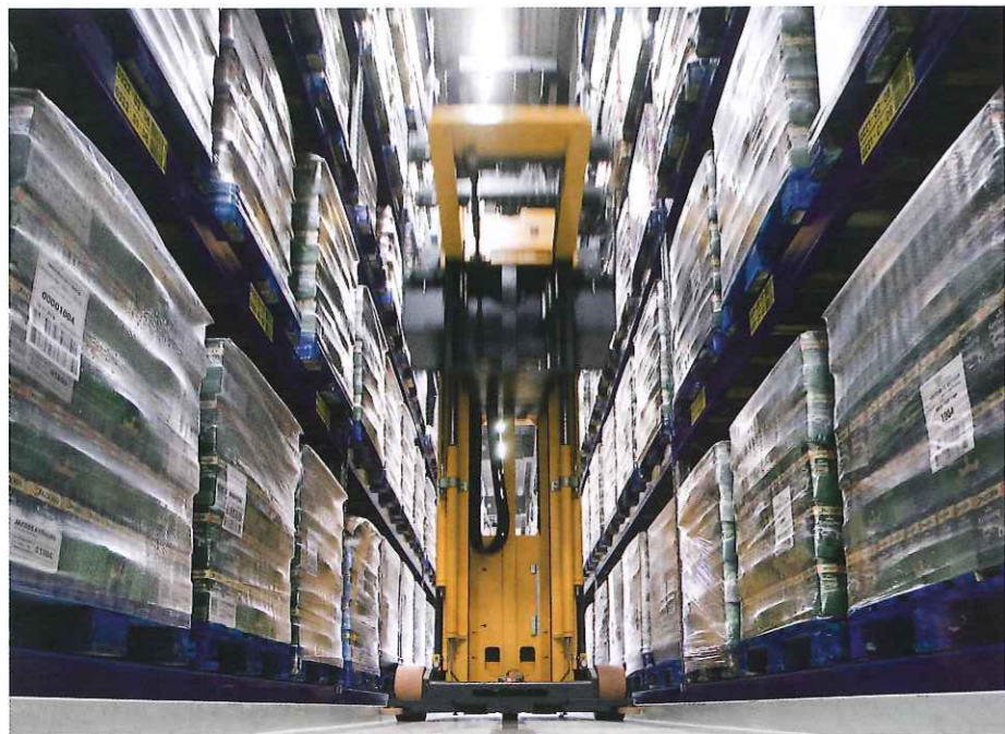
Im Multicube: Ein Hochregalstapler im Bereich von Kraft Foods.
