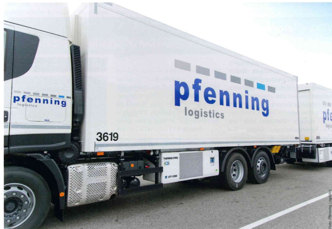
Die Unterflur-Kühlmaschine UT Spectrum im Einsatz bei Pfenning Logistics.
