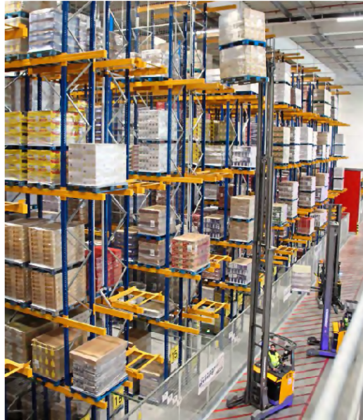
Hand in Hand: Schubmaststapler und Regalbediengeräte kooperieren am Schmalganglager. Eine Drohne prüft testweise die Bestände und übermittelt sie ins Lagersystem.
